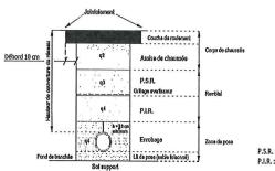
P.S.R. : Partie Supérieure de Remblai P.I.R. : Partie Inférieure de Remblai
