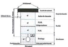
P.S.R.: Partie Supérieure de Remblai P.I.R.: Partie Inférieure de Remblai
